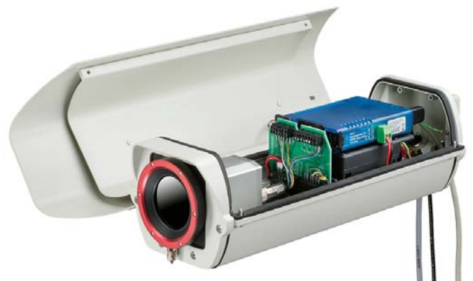
Outdoor-Schutzgehäuse mit Wärmebildkamera der PI Serie
