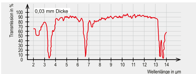
Spektrale Durchlässigkeit von Kunststofffolien aus Polyäthylen
