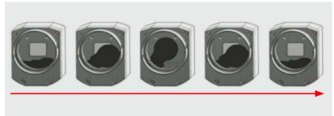
Zur Offsetreferenzierung wird in das Gesichtsfeld des Infrarot-Sensorarrays kurzzeitig eine Temperaturreferenz hineinbewegt.
