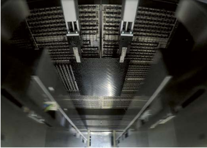
Kleiner CT LT-Messkopf mit Laminar-Freiblaseinrichtung in einer Thermoforming-Maschine
