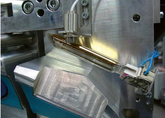
Infrarottemperaturmessung in Verpackungsmaschinen
