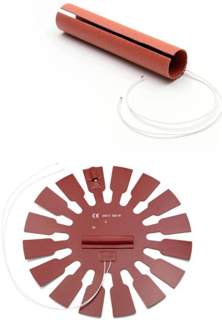
Für Kleinserien sowie Anwendungen über 200 °C werden die Silikonheizmatten per Hand gefertigt. Dabei wird der **Widerstandsdraht** mit Hilfe eines Steckbrettes mäanderförmig auf Kundenmaß gelegt. Bei größeren Stückzahlen wird mechanisch eine **Widerstandsfolie** auf die Silikonschicht aufgetragen, in Form gebracht und anschließend mit einer zweiten Silikonschicht verschlossen.
